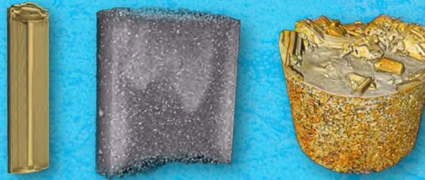
◀ Illustrations d'échantillons analysés par micro tomographie : de gauche à droite une batterie lithium-ion, une roche subissant une injection de CO<sub>2</sub> et un clathrate utilisé dans le captage de CO<sub>2</sub>
