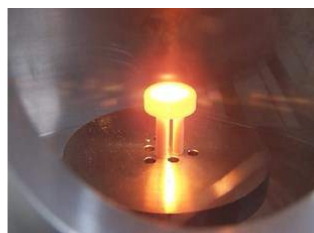
Emission thermique d'un échantillon chauffé à haute température par laser CO 2
