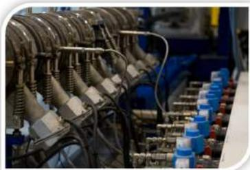
De très nombreux produits et sous-produits agricoles ont ainsi été traités au LCA par extrusion bi-vis afin d'être déstructurés pour devenir thermoplastiques, pour améliorer leurs propriétés, pour extraire sélectivement certains composants, pour les mélanger avec d'autres liants, pour les préparer à des biotransformations (production de bioéthanol ou de biométhane par exemple), etc.
