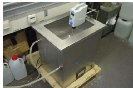
*10 litres solution aqueuse sel basique + tensioactif + 1kg chips PVB souillé dans cuve ultra-sons à température, fréquence et puissance contrôlées*
