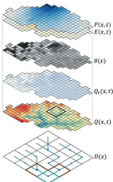
Principe de la modélisation hydrologique distribuée dans SMASH avec de haut en bas : les forçages météorologiques distribués (pluie P, évapotranspiration E...), les grilles de paramètres et d'états internes du modèle, les grilles de débits modélisés et les débits agrégés à l'exutoire des bassins versants par routage en fonction des directions d'écoulement.
