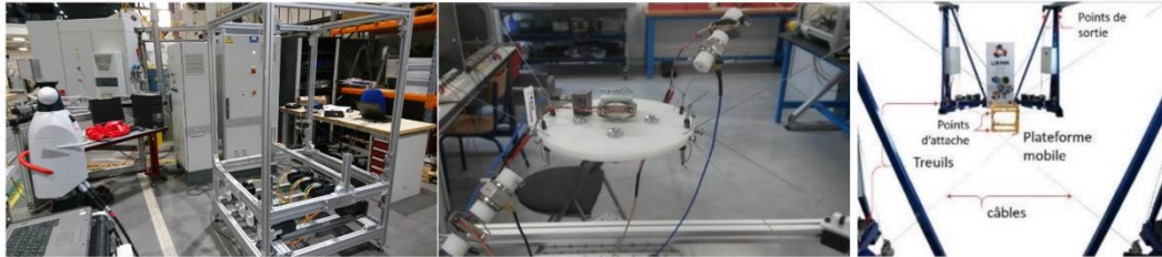
Figure 1 : Prototype de CDPR à 6 ddl et 8 câbles de l'IP avec un laser tracker pour la calibration géométrique
