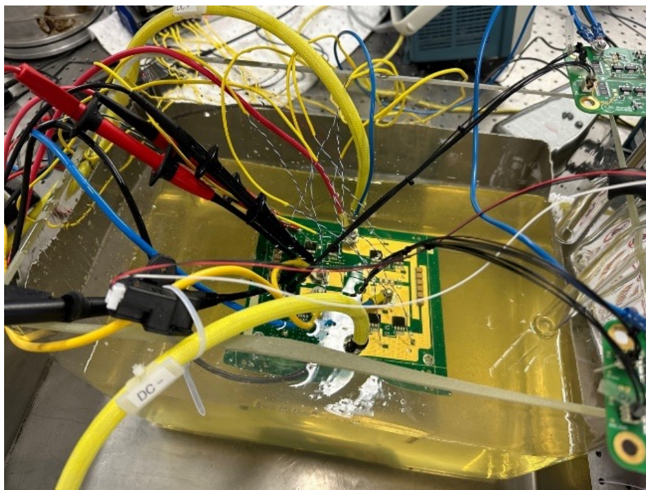
Carte de puissance à base de composants WBG en fonctionnement représentatif immergée dans un bain d'huile diélectrique.
