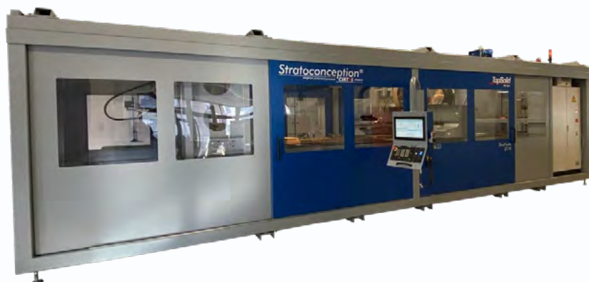
FA Strat'Auto MECANUMERIC : machine automatique pour la FA de grandes dimensions par Stratoconception
