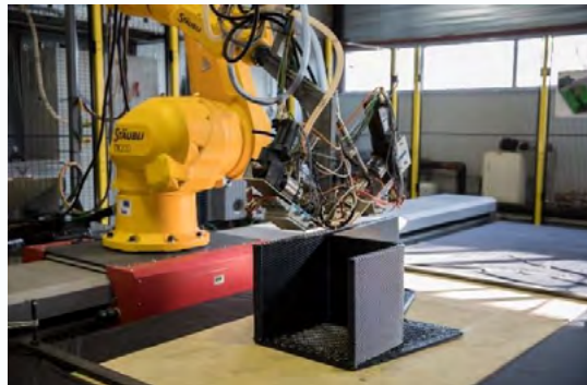
Fabrication additive robotisée LASCALA de pièces de grandes tailles (jusqu'à 6mx2mx1m) en thermoplastiques et composites (extrusion de matériaux, alimentation avec granulés de polymères, renforcement avec fibres coupées ou continues) © IMT Nord Europe (développement en propre)
