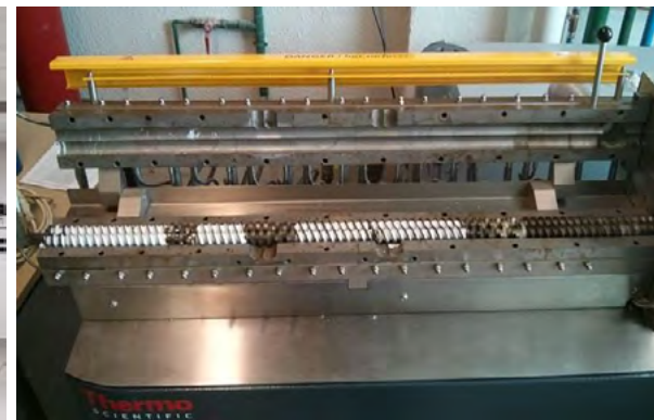
Extrudeur depuis qqg jusqu'à 20kg/h (microcompounder DSM Explore, PS 11, PTW24)
