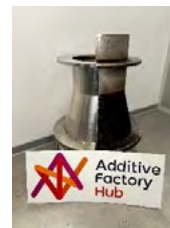
Etude et développement de la fabrication hybride d'une tuyère en 316L
