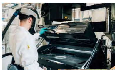
Moyen PBF-LB Aconity 2 lasers + beam shaping + préchauffage Hte T° (1000°C)
