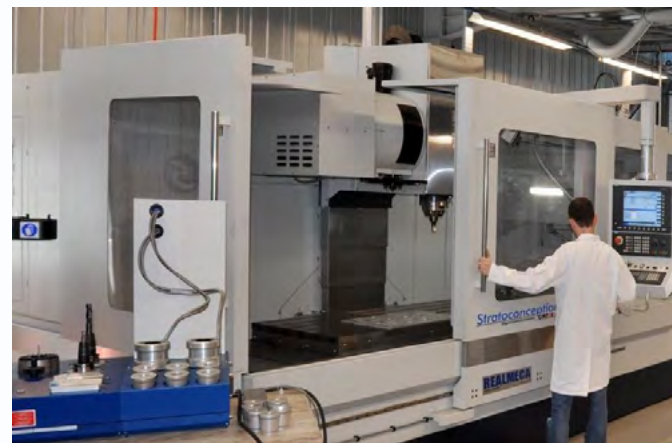
SPINNER MVC 1600 : Centres d'usinage 3 axes Intégrés FA Stratoconception - capacité : X1600 mm x Y800 x Z Illimité
