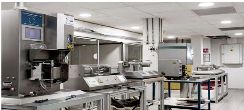
Extrudeur depuis qqg jusqu'à 20kg/h (microcompounder DSM Explore, PS 11, PTW24)
