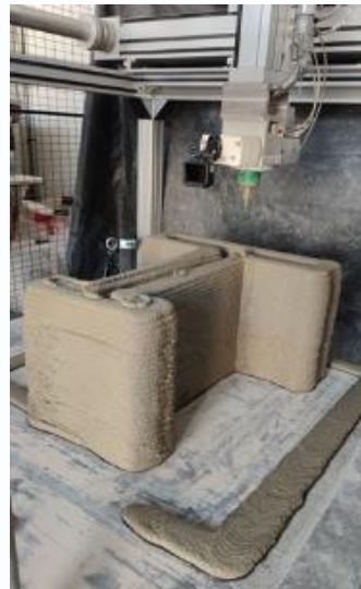
Impression 3D béton : Formulation d'encres cimentaires bas carbone © IMT Nord Europe (développement en propre)
