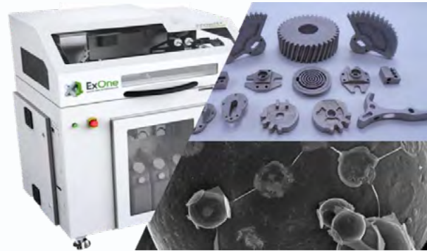
Metal Binder Jetting (modification laboratoire pour étude de la santé matière) @Mines Paris-PSL
